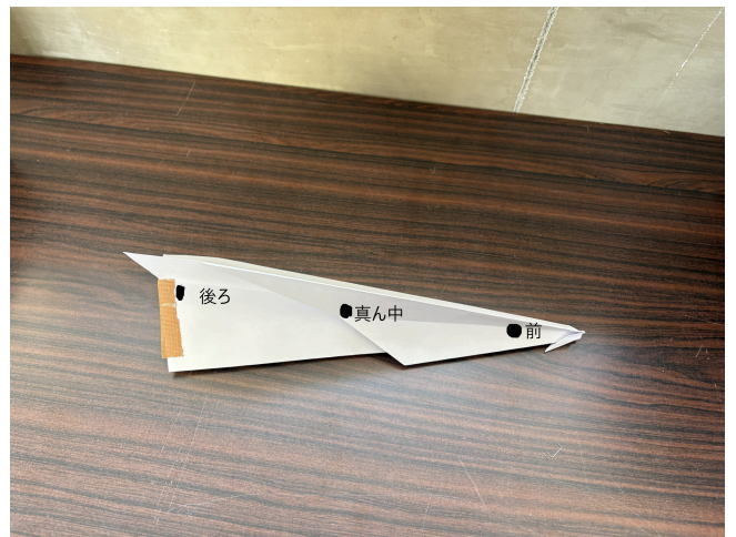
(写真2) 先折れ紙飛行機とおもりの位置
